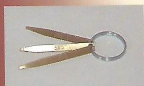
■ Są to metalowe pręty z przylutowanymi złotymi końcami o ścisłe określonej próbie. Służą jako wzorzec do określenia próby złota badanego przedmiotu w trakcie badania na kamieniu probierczym. Komplet składa się z 3 sztuk do badania próby złota 0,333 (8 Kt); 0,585 (14 Kt); 0,750 (18 Kt)
